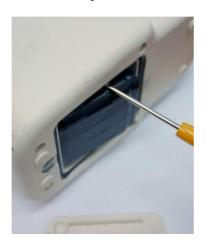
Vérifier que l'appareill est hors tension. Ouvrir la trappe d'accès au pack batteries comme indiqué ci-dessus. Insérer un petit tournevis ou bien un instrument ad hoc entre le pack batteries et la parroie gauche ou droite du logement, faire doucement levier pour extraire le pack, il doit venir sans effort.
