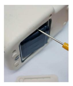
Emplacement du compartiment batteries. Voir les instructions du manuel pour retirer le pack batteries.
