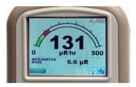
Le modèle 9DP est équipé d'un écran LCD couleur qui permet à l'utilisateur d'interpréter facilement les informations présentes, taux de comptage, échelle, fonction utilisée, alarme, comparé à un afficheur monochrome. L'utilisation du bitmap de cet écran permet un arangement optimise des données disponibles.
