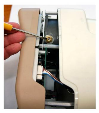
**Etape 1**S'assurer que l'appareil est hors tension puis retirer les batteries comme indiqué ci-dessus.
