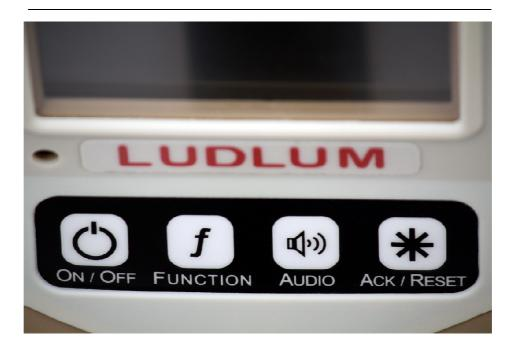
L'appareil est équipé d'un clavier de quatre boutons poussoirs, montré ci-dessus. Tout le contrôle du DP9 se fait à travers eux. Chaque touche a une ou plusieurs fonctions dédiées.
